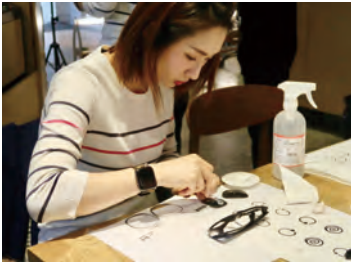
4. 將自己設計或喜愛的圖案由雷射雕刻機鐫刻在墨鏡的鏡片上，再藉由網點狀的設計，選擇喜歡的顏色，將顏色填入雕刻的紋路中，讓花紋活過來，就像是公車廣告原理，不影響你的視線喔。
